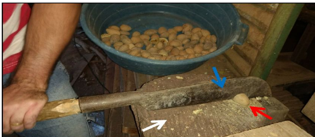
FIGURA 7 – Cortador de foice de amêndoas do Dipteryx alata Vogel. Mecanismo desenvolvido por artesãos de Pirenópolis em 1988 para quebra do endocarpo lenhoso sem danificar a amêndoa. Um pedaço de vigota (seta branca) com uma superfície convexa (seta vermelha) para inserção dos frutos do Dipteryx alata Vogel e uma foice adaptada (seta azul). Fonte: Arquivo pessoal (2017).
