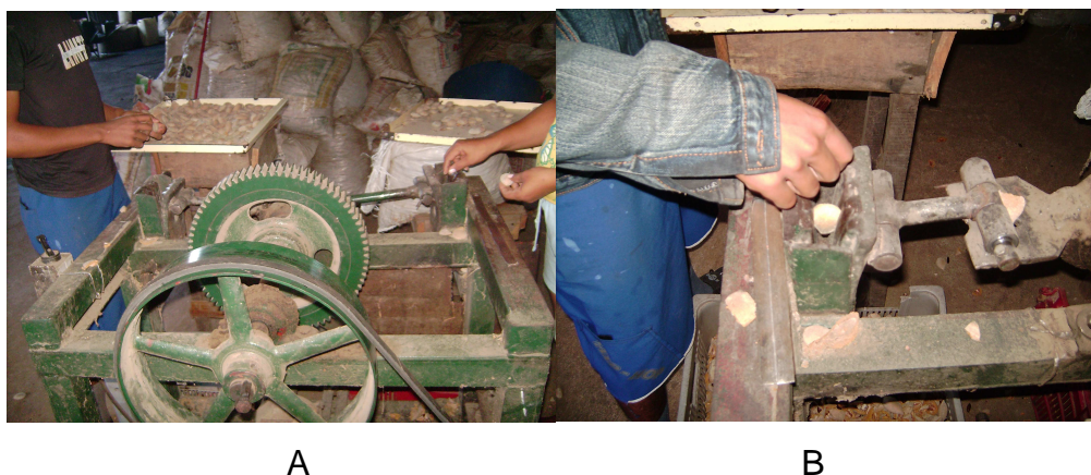
Figura 5.6. Equipamento para extração de amêndoa na UP2 (M2): A) visão geral; B) detalhe da alimentação do equipamento.
