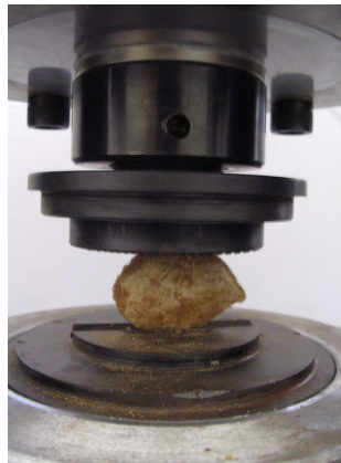
Figura 4.11. Acomodação inicial do espécime na máquina universal de ensaios.
