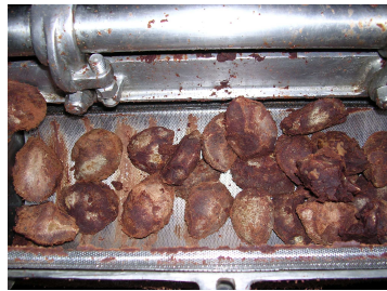
Figura 5.28. Frutos despolpados resultantes da operação em despolpadora a facas.
