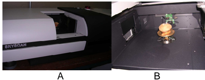
Figura 4.14. A) Microtomógrafo por raios-X e B) detalhe da acomodação do baru.
