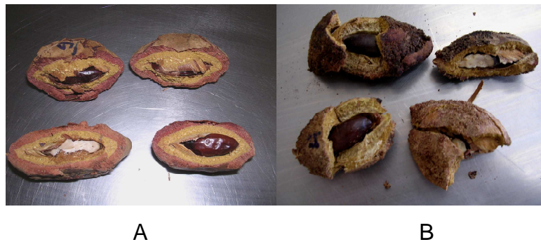
Figura 5.34. Baru submetido à aplicação de força ao longo da espessura: A) com polpa (CP) e B) sem polpa (SP).
