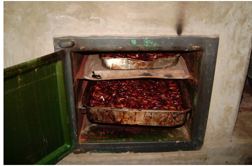
Figura 5.7. Forno à lenha para a torração das amêndoas na UP2.
