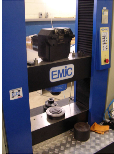
Figura 4.8. Máquina universal para ensaio de materiais com capacidade máxima de 300 kN.
