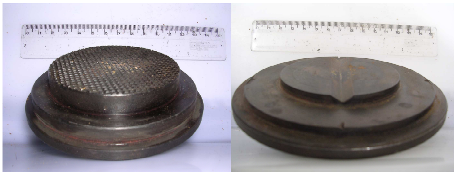
Figura 4.9. Dispositivos desenvolvidos para evitar o deslizamento do baru na extração da amêndoa em máquina universal de ensaio de materiais, fixados nas partes: A) superior, com superfície recartilhada e B) inferior, com rebaixo em forma de 'V'.
